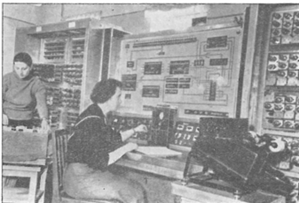
Obr. 6. Stroj S E S M. (Specializirovannaja elektr. sčotnaja mašina.) Stroj je určen pro hydrotechnické stavební výpočty.
