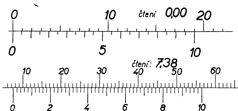
Obr. 3. Dvacetinový ( n = 20 ) a padesátinový ( n = 50 ) nonius stejnosměrný.
