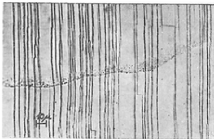
Obr. 3. Skluzové pásy na monokrystalu mědi při pozorování metalografickým mikroskopem.
