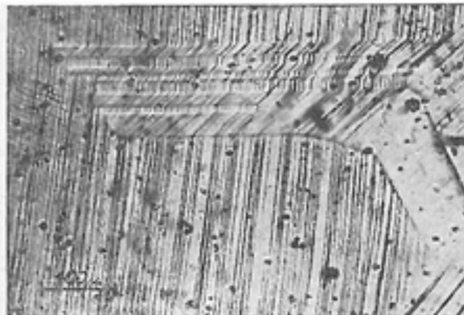
Obr. 7. Skluzové čáry na polykrystalickém niklu s žihacími dvojčaty.
