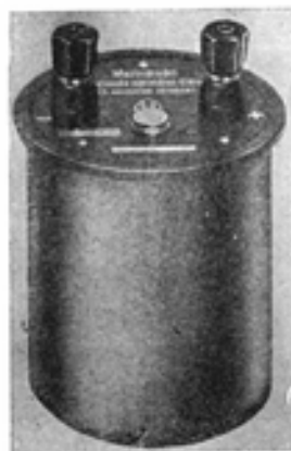
Obr. 68,2. Normální kadmiový článek Westonův .
