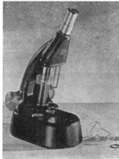
Obr. 96,2. Kolorimetr fy Spencer s vestavěným osvětlovacím zařízením.
