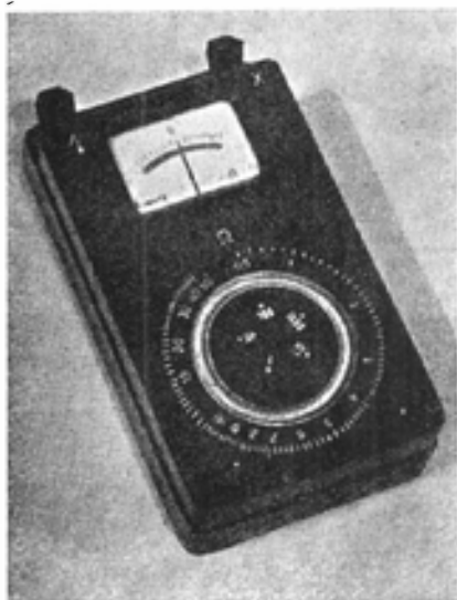
Obr. 71,8. Ohmmetr Omega (0,05–50 000 \Omega ).
