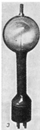
Obr. 92.9. Vakuové fotočláanky s anodou uprostřed:
