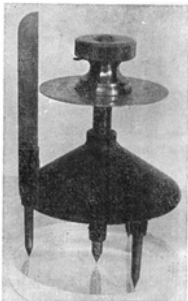
Obr. 31,9. Sférometr na kulové ploše čočky. Obr. 31,10. Indikátor na měřicím stojánku.
