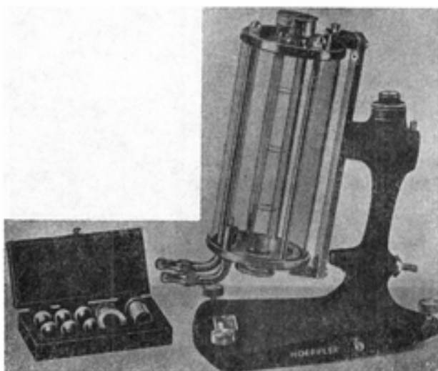
Obr. 45,11. Hoepple ův vazkoměr tělískový.
