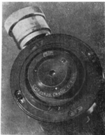
Obr. 20,7. Zeissův okulární mikrometr.
