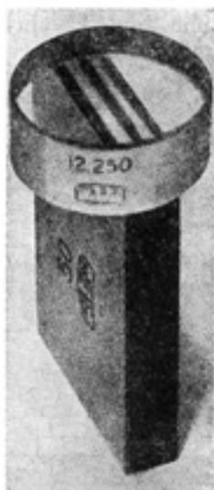
Obr. 31,2. Interferenční proužky vzniklé přiložením skleněné destičky ke koncové měrce.
