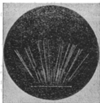
Obr. (8.4) 25. Stopy záření \alpha z ThC a ThC' v expanzní komoře
