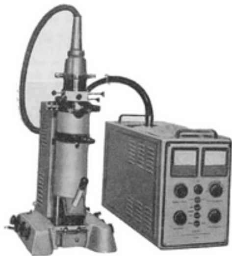
Obr. (6.7) 20. Elektronový mikroskop Tesla BS 242A se zdrojem napětí
